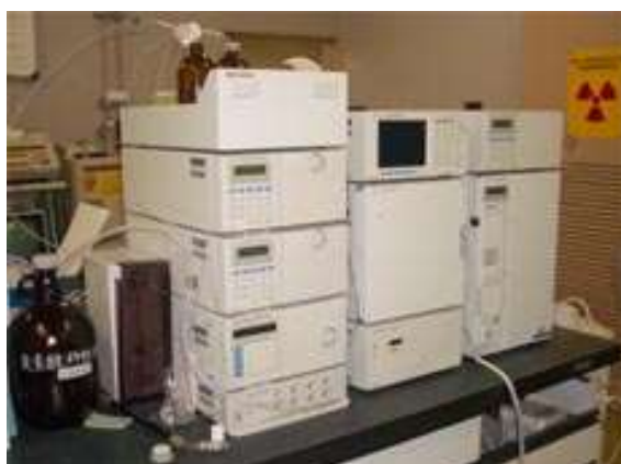
イオンクロマトグラフ（ポストカラム式） シアン、臭素などを検査します。
