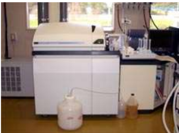
誘導結合プラズマ質量分析計 カドミウムや鉛などの金属類を検査します。
