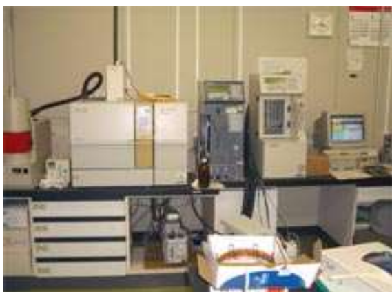
ガスクロマトグラフ質量分析計 トリハロメタンなどの有機化合物を検査します。
