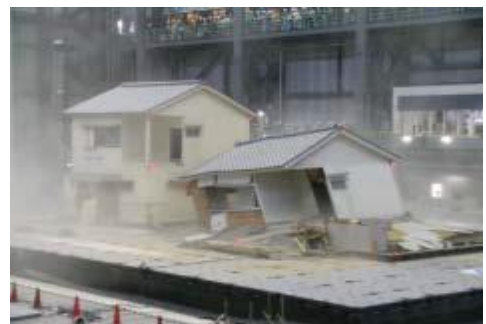
(左:耐震補強あり 右:耐震補強なし)
