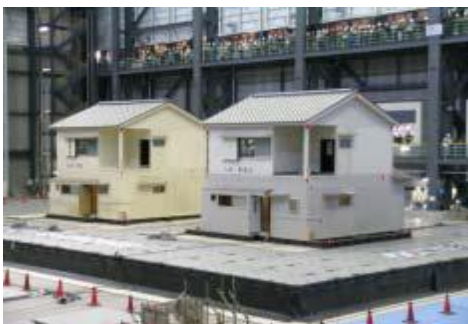
(左:耐震補強あり 右:耐震補強なし)
