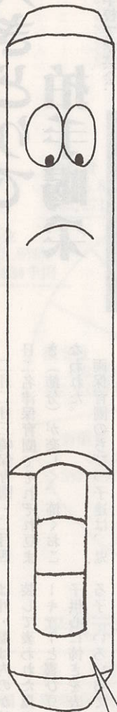
第1のカベ ペレット ウランをタバコのフィルター ぐらいの大きさに焼き かためたもの
