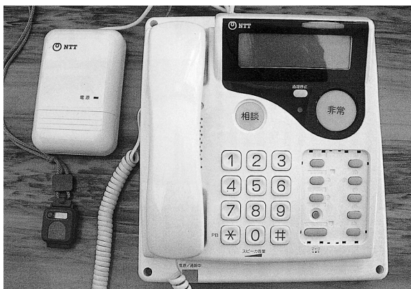
緊急通報システム装置
